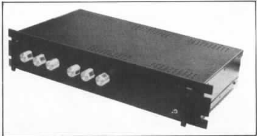
1. Le filtre habillé dans un coffret 2U.
