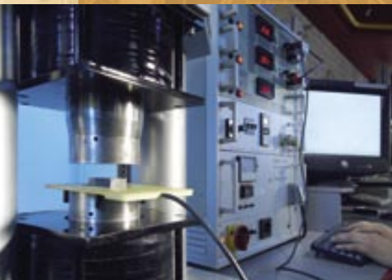
Le Permagraph permet de vérifier si les aimants satisfont aux valeurs magnétiques prescrites, jusqu'à une température maximale pouvant atteindre 200 °C !
