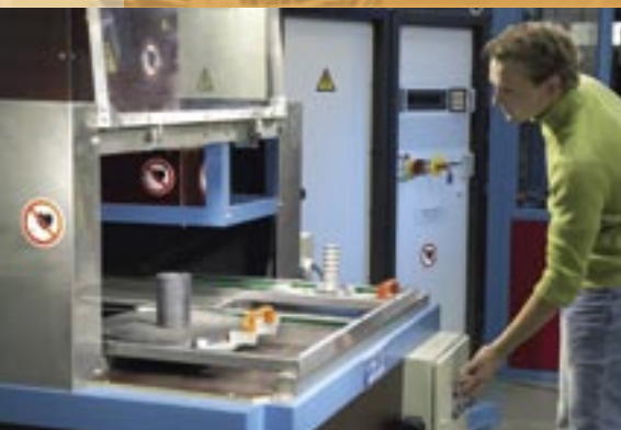
La magnétisation et la démagnétisation des aimants sont effectuées dans nos propres locaux.
