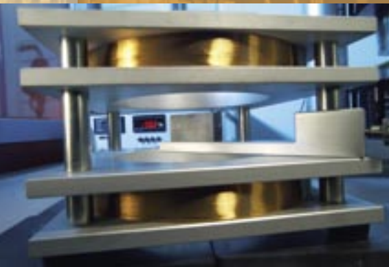
On utilise une bobine de Helmholtz, en association avec un fluxmètre pour mesurer avec précision et rapidité des formes diverses et complexes d'aimants SmCo, Neoflux® et ferrite, magnétisés.
