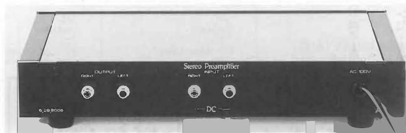
リアパネルにあるのは入出力端子とACケーブルインレットのみ
