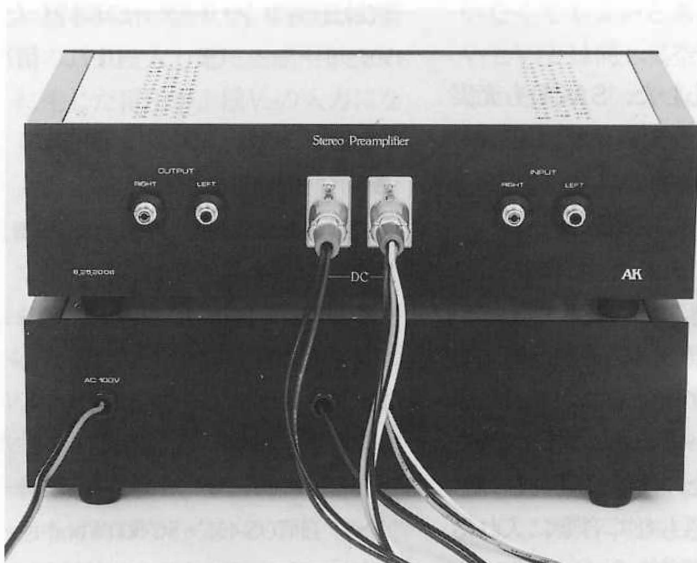
下側の電源部からヒーター電源とB電源を個別に供給。入出力端子は半導体式と同様にスーパーロン研究所製
