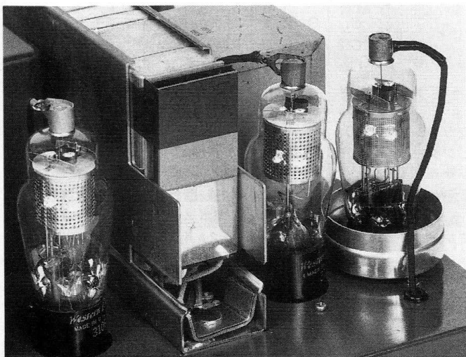
[写真7] 初段の 310A はシールドケースに収める
