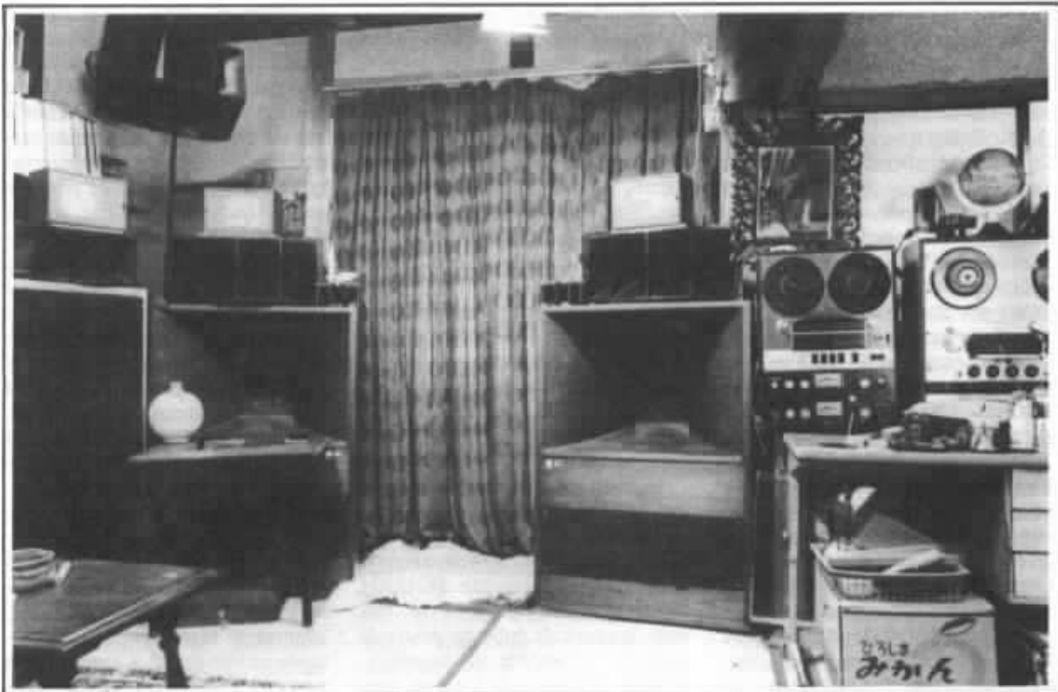
Le système de M. Okada, en 1973 : enceintes Altec «Voix du théâtre», tweeters à chambre de compression et électrostatiques. A gauche, une partie d'un second système disposé orthogonalement par rapport au premier. On remarque en haut et à gauche les pavillons de chambres de compression d'origine Kato.
