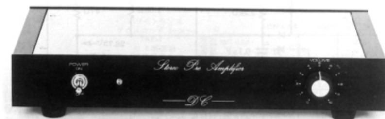
コンパクトなシャーシながら電源部も内蔵した半導体式CDラインアンプ。反転増幅アンプの採用で、従来のミュートスイッチなしで音量をゼロにできる
