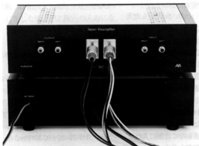
下側の電源部からヒーター電源とB電源を個別に供給。入出力端子は半導体式と同様にスーパーロン研究所製
