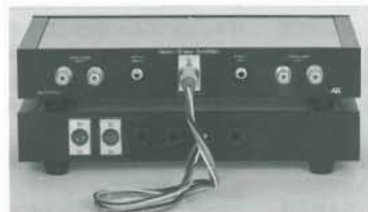
下側の電源部から上側のアンプ部への電源供給には6ピンのXLRコネクタを使用。電源部に電力を供給するバッテリーは2種類あるため、コネクタも2ピンと5ピンを備える
